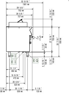
Electrical inlet (power) ΕI Equipotential screw
