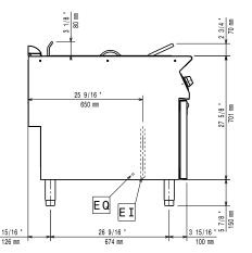
Electrical inlet (power) Equipotential screw
